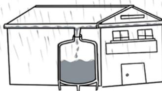
下雨時，雨水會沿著屋簷流入溝渠，最後接到雨水撲滿裡。
